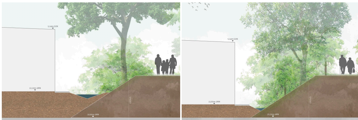
Abbildung 8: Schemaschnitt nördliche Böschung (West)
